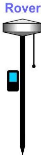
Como característica estándar, el receptor incorpora un módem GSM. Monte los distintos elementos tal como se muestra en la figura anterior, incluido el receptor, el bastón, y la terminal con su soporte de montaje.
